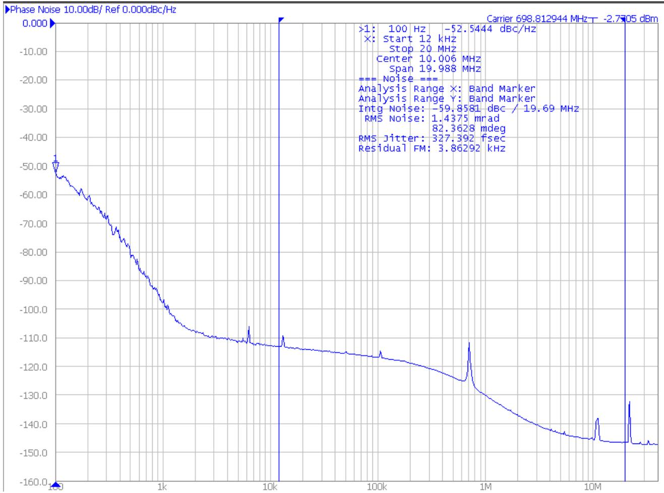
Figure 101. Si5374, Si5375, and Si5376 DSPLL B
